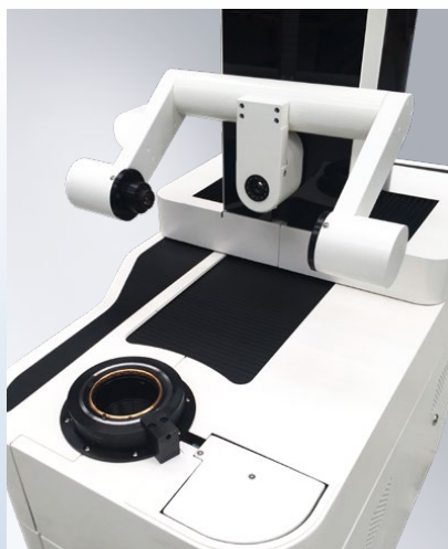
Axe Y mobile pour les outils de mesure, dont l'arête de coupe n'est pas centrée (en option) Asse Y movimentabile, per la misurazione di utensili il cui tagliente non è in asse (opzionale)
