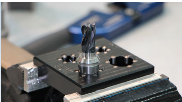
Pinza Duo-Lock avec tête de fraisage Duo-Lock et dispositif de serrage/ Pinza Duo-Lock con testa a fresare Duo-Lock e dispositivo di serraggio
