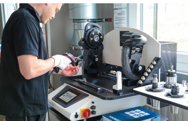
Der Bediener liest mit einem Handscanner den QR-Code auf der Schrumpfspinnzange aus. Das Schrumpfgerät erhält damit alle wichtigen Schrumpfparameter/ The operator reads the QR code on the shrink fit collet with a hand scanner. The shrink fit machine is then provided with all important parameters.
