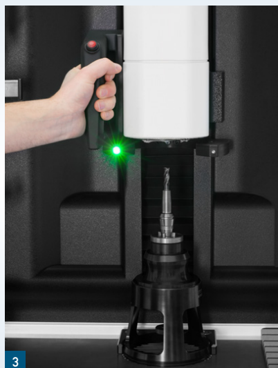
Abkühlung der Schrumpfspannzange mit Temperaturkontrolle Cooling of shrink fit collet with temperature control
