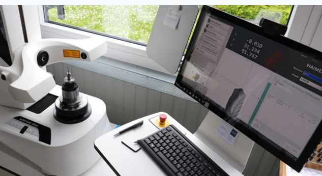
Das Werkzeugvoreinstellgerät HAIMER Microset UNO 20|40 automatic drive verfügt über ein Bildverarbeitungssystem und eine automatische Werkzeugvermessung in drei Achsen./ The HAIMER Microset UNO 20|40 automatic drive tool presetter features an image editing system and automatic tool measurement in three axes.
