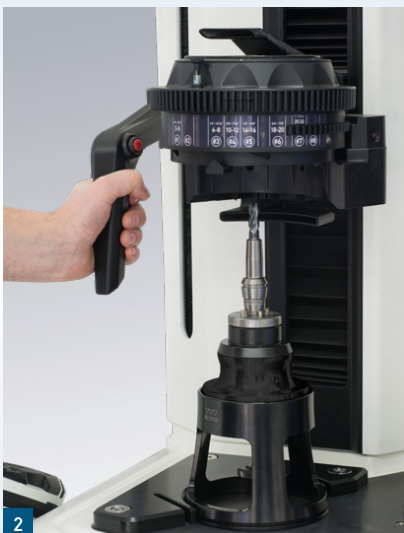
Schneller Schrumpfvorgang Fast shrinking process
