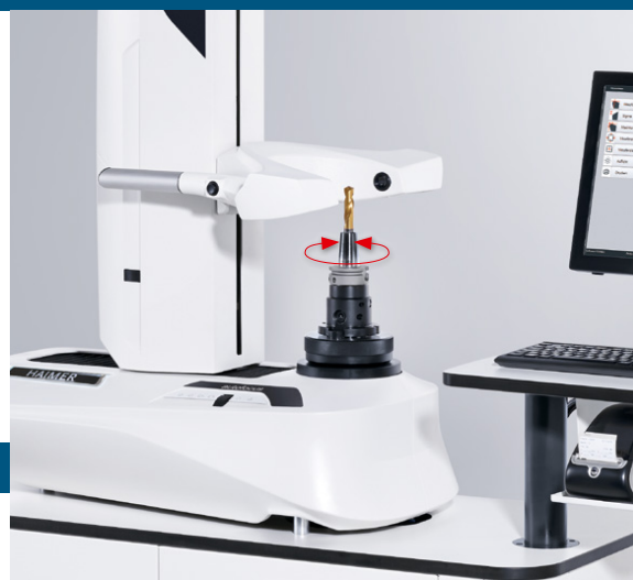
공구날의 자동 초점기능 Automatic focus on the cutting edge
