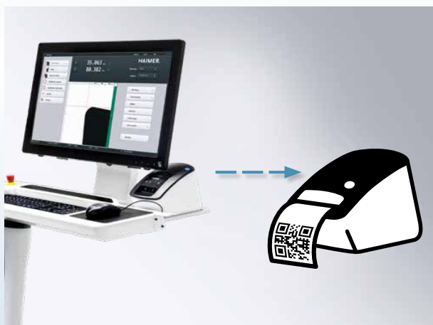
Después de la medición de la herramienta, una etiqueta con el código QR se imprime Após medir a ferramenta, uma etiqueta com o código QR é impressa
