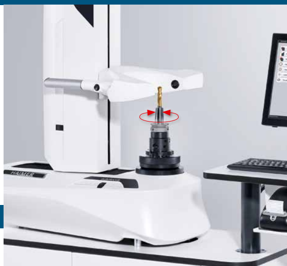
Enfoque automático del filo de corte Autofocus automático da aresta de corte
