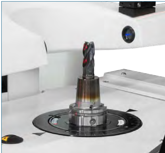
通过高分辨率的相机和电子成像工艺实现非接触的测量，包含 Microvision 测量软件
