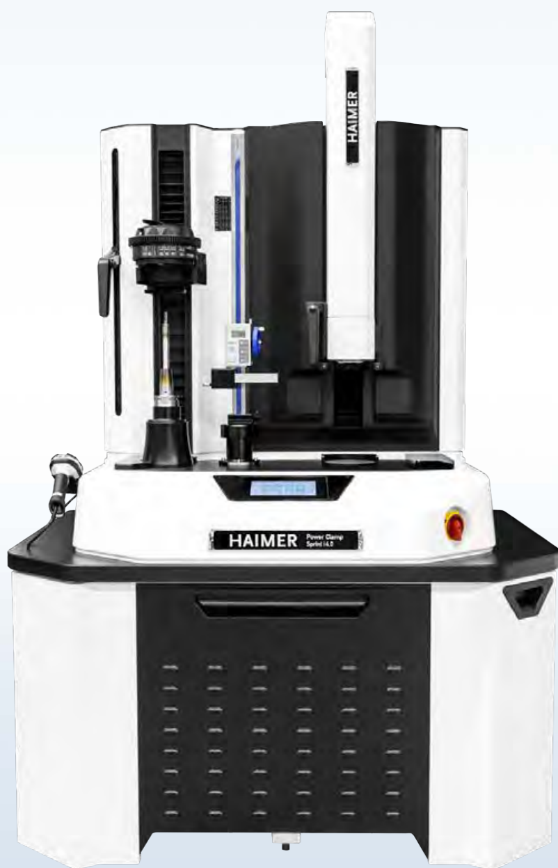
图片显示为配置长度预调单元及扫描枪 (选配) 的 PC408-I22-C21-EU 热缩机 Picture shows PC408-I22-C21-EU with length presetting and scanner (optional)
