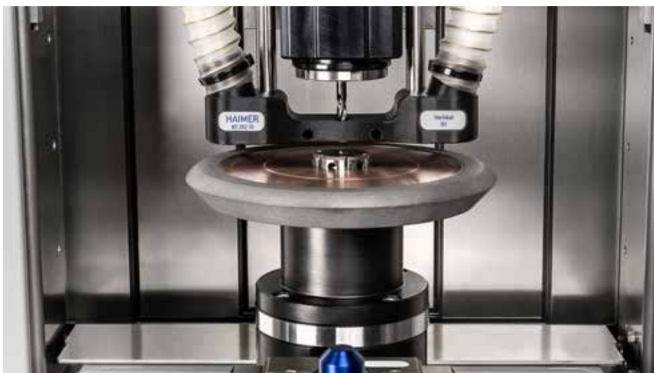
Équilibrage d'une meule par perçage axial
