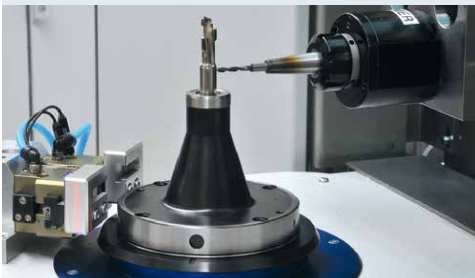
Équilibrage d'attache-ments à l'aide d'adaptateur d'équilibre HG pour des outils à tige
